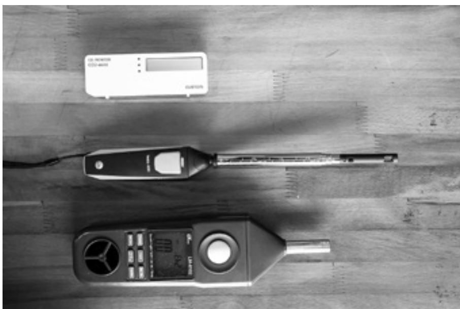
測定機器 上：CO 2 濃度計 中：風速計① 下：風速計②
