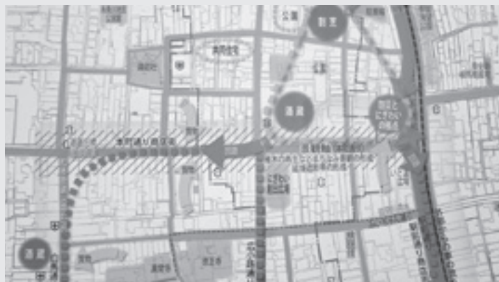
▲糸魚川駅前にあるヒスイ王国館を拠点に、にぎわいのある、まちづくりを推進 本町通りにおける延焼遮断帯の形成 「糸魚川駅北地区防災街区整備地区計画」を決定 木造の建築物が密集する地域における建築物の不燃化に対する支援 市独自の防火仕様を設定 被災地域における敷地再編による木造建築物が密集する地域の解消 雁木や酒蔵等をはじめとする本町通りの歴史的町並みの再生
